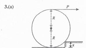
दिए गए चित्र में दिखाए, त्रिज्या R और वज़न W वाले सिलिन्डर को बल P द्वारा सीढ़ी पर बिना फिसले चलाने के लिए, सीढ़ी की अधिकतम ऊँचाई x कितनी होगी ? स्थैतिक घर्षण गुणांक  $\mu_s$  है । 10 What is the maximum height x of a step in the figure so that a force P will roll a cylinder of radius R weighing W over the step with no slippage at all. The coefficient of static friction is  $\mu_s$ .
